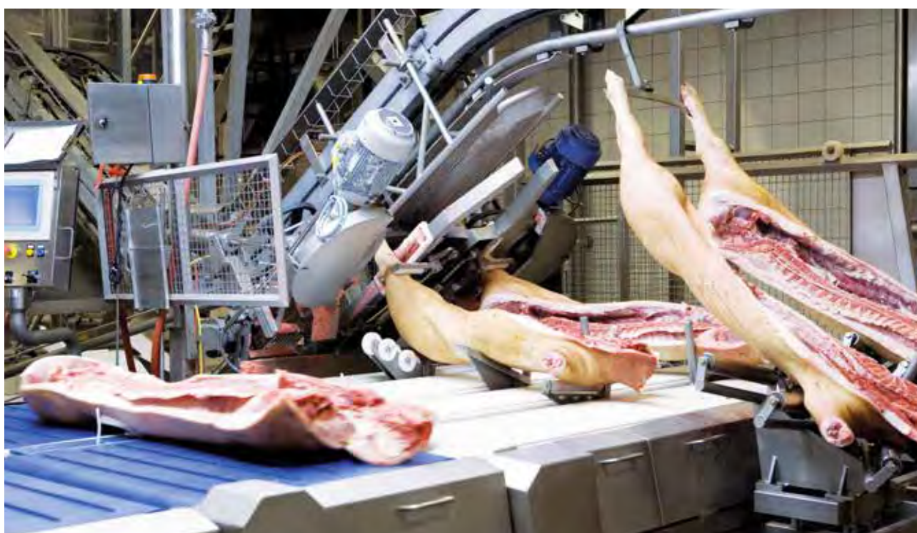
De två slaktkroppshalvorna placeras automatiskt på ett transportband varefter bakfötterna avsågas.
