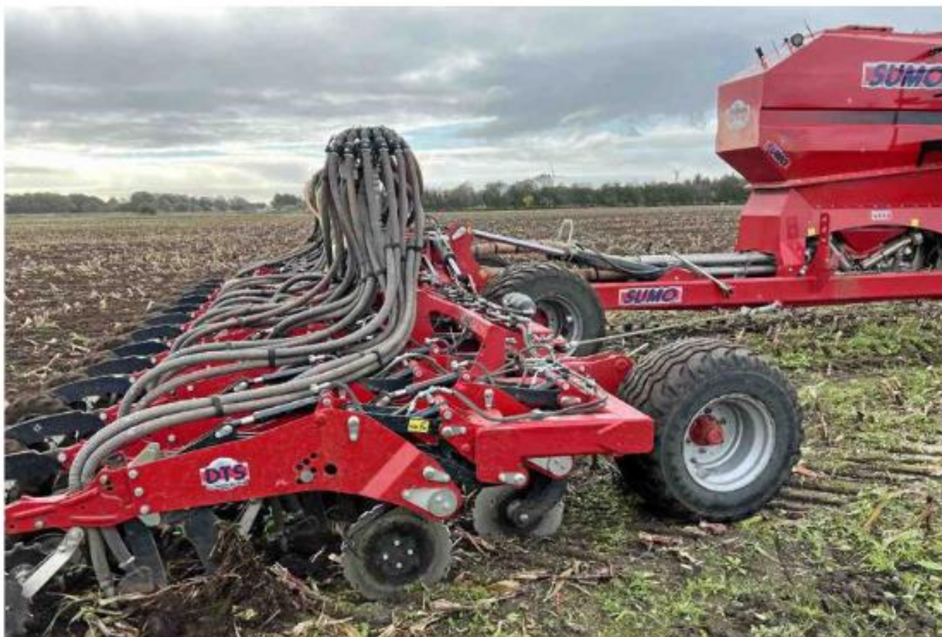
En brittisk såmaskin, Sumo, sår både spannmål och majs direkt i stubben.
