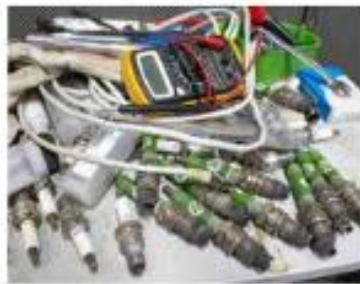
Det går åt tändstift till de 12-cylindriga MAN-motorer som driver generatorn.
